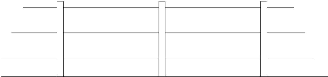
4. Per la protezione di orti e ricoveri per animali sono consentite recinzioni realizzate in legno con struttura a tronco tondo, naturale o verniciato, per i montanti verticali e rete metallica plastificata di colore verde fissata a questi.
