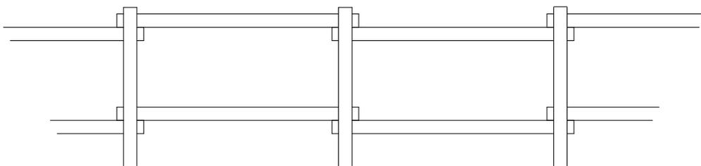
3. Per la delimitazione delle opere pubbliche (quali sorgenti, pista altiporto, ecc.) sono ammesse recinzioni realizzate con montanti verticali in legno con struttura a tronco tondo, naturale o verniciato, e cavi di acciaio in luogo delle traverse orizzontali.
